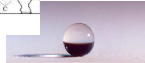
超撥水めっき皮膜 (接触角 170^\circ )
