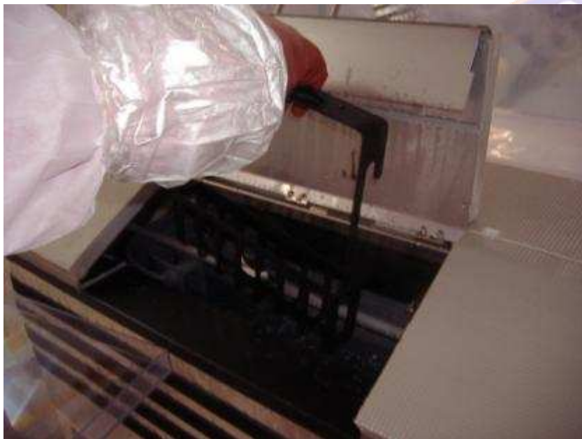
化学除染槽への試験片投入
