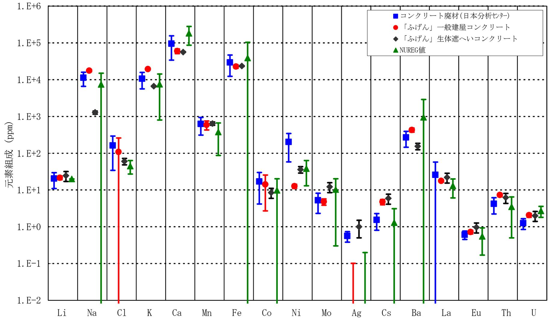
Fig.6 構造材の元素組成の分析結果 (コンクリート)
