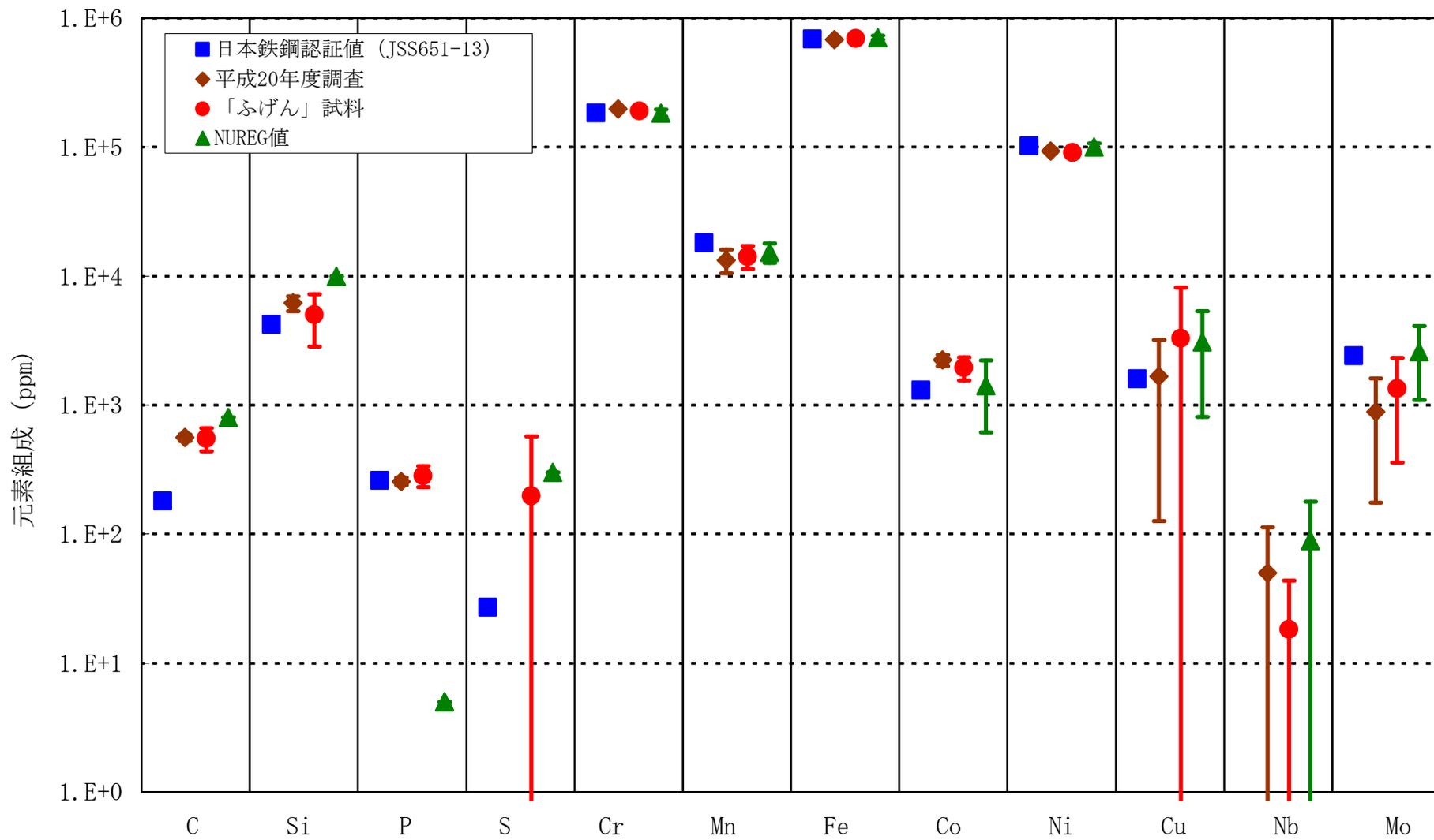
Fig. 4 構造材の元素組成の分析結果 (SUS304)
