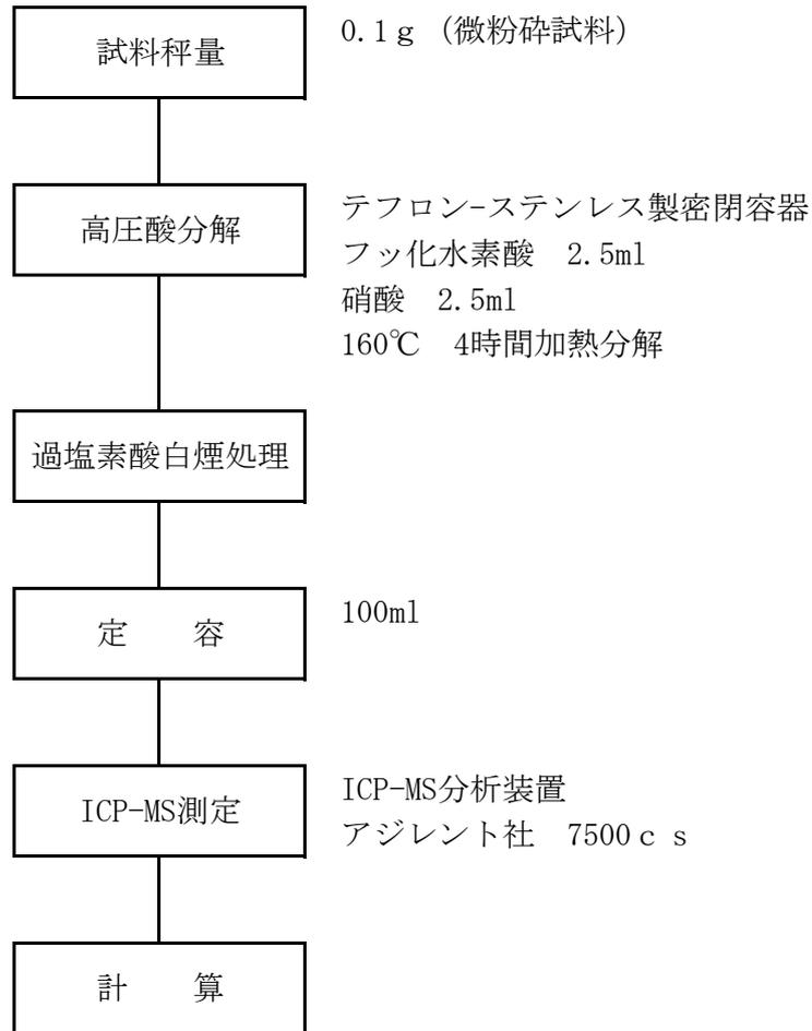
Fig. 3 ICP-MSによる分析フロー (コンクリート)
