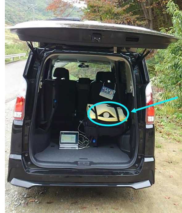
検出器の 設置個所 高さ1m
