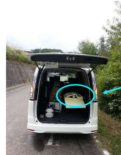
検出器の 設置個所 高さ1m
