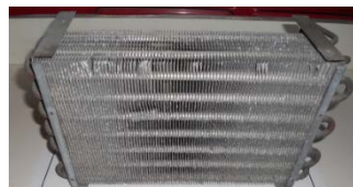
写真2 自動販売機ラジエータ外観
