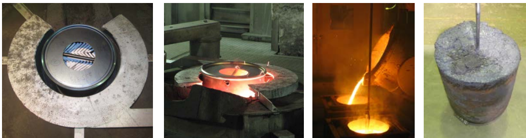
誘導炉への材料装荷 誘導加熱の実施状況 铸造の実施状況 金属固化体
