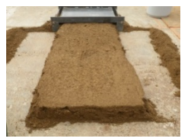
写真 5-5 型枠整形結果(泥 DRY)
