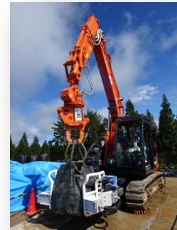
図 1 試験フロー(左)とバックホウ型放射線計測装置による測定の様子(右)
