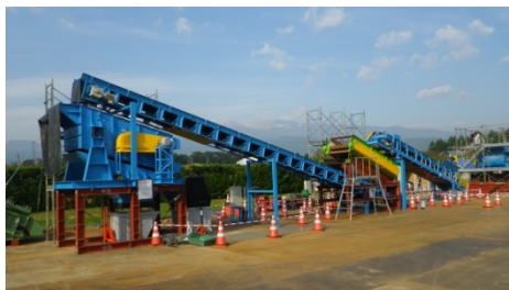
写真 5-2 選別ライン(50mm ロールスクリーン、20mm 振動ふるい)
