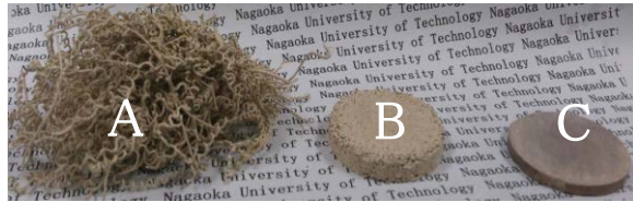
図2 繊維状吸着材の減容化(A-C)、及び繊維の断面SEM写真(D)、Bは繊維を100kg/cm 2 で圧縮したペレット。Cは400℃熱処理により融解した繊維。母材がゼオライト粒子を包み込み安定化する構造。
