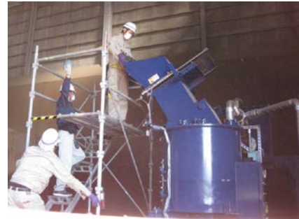
写真 3-1 CFS への供試体の投入状況
