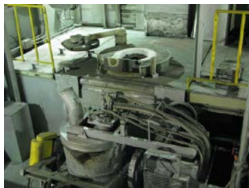
図 2-3 実証規模誘導炉の外観及び仕様
