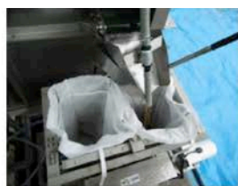
写真 3-20 凝集フロック回収装置
