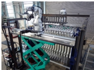
写真 3-15 リフトでロボットを上げる
