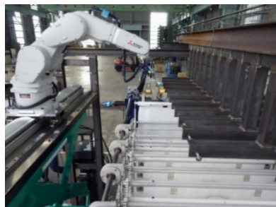
写真 3-16 ろ布吊り上げ、開始
