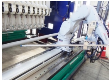
写真 3-9 リターンロール引抜き
