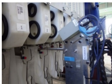
写真 3-13 ハンドを傾斜して タイクランプを押して外す
