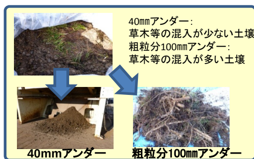
図-2-2 前処理設備の効果（宅地除染土）
