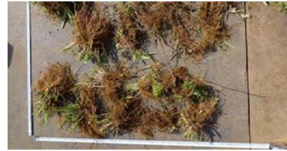
写真 5 R/S(50mm)で軽量物側へ分別された草根
