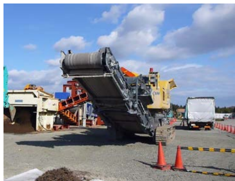
農地除染土3袋分からの粗粒分を 破碎機で処理
