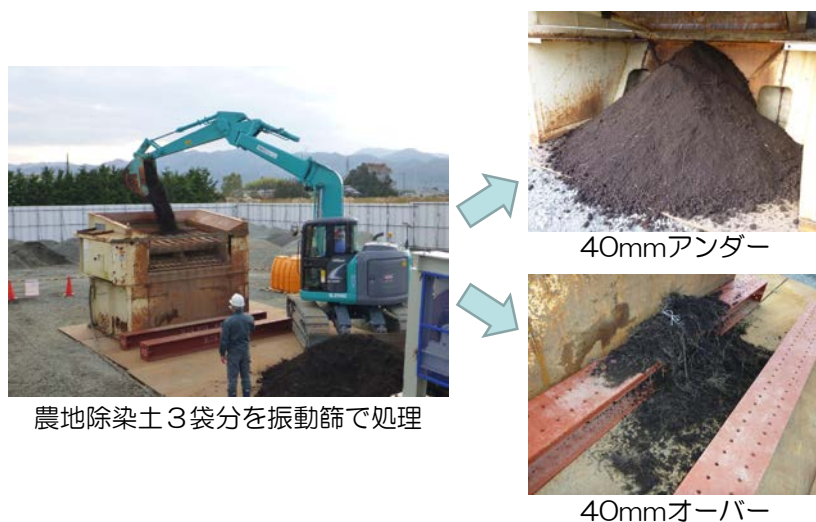
写真－8 振動篩による農地除染土の篩い分け状況
