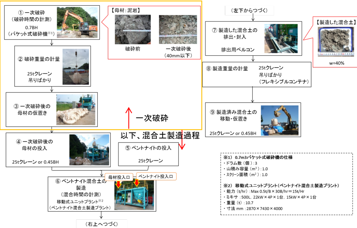
図 2-1 ベントナイト混合土の製造フロー
