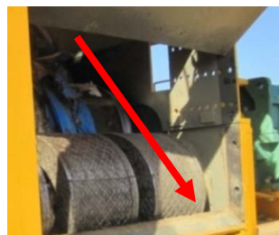
写真 1-5 イジェクタ機構の構造
