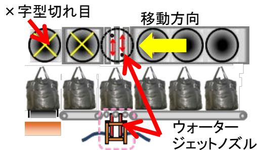
図-2-1 搬送・破袋システムのイメージ
