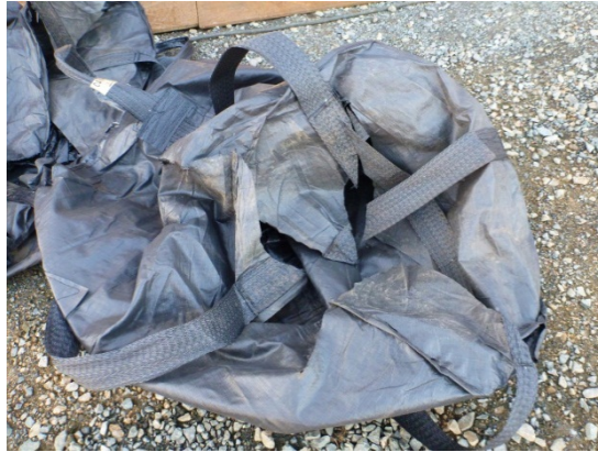
写真-4 フレキシブルコンテナ底面の破袋状態
