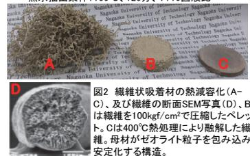
図2 繊維状吸着材の熱減容化(A-C)、及び繊維の断面SEM写真(D)、Bは繊維を100kg/cm<sup>2</sup>で圧縮したペレット。Cは400℃熱処理により融解した繊維。母材がゼオライト粒子を包み込み安定化する構造。
