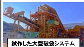
試作した大型破袋システム
